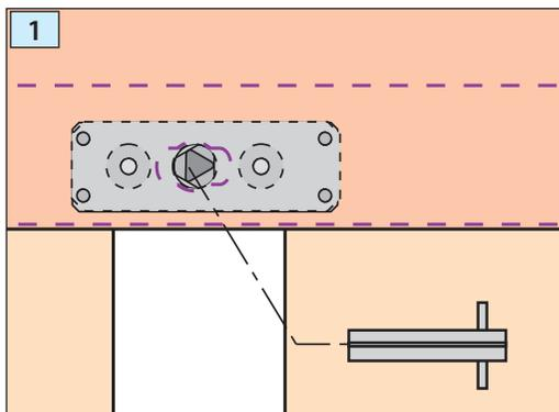
Das CEX/ORLY hat einen Wasserdichten 4A / 220 V Wender-Kontakt. Dieser Kontakt wird mit dem Dreikantschlüssel aktiviert sobald dieser gedreht wird um die Tür zu öffnen. Dieser Kontakt freigegeben kann er zum Beispiel einen Alarm oder die Beleuchtung des Fahrschachts aktivieren. Sobald der Schlüssel nicht mehr benützt wird wird der Kontakt unterbrochen.
